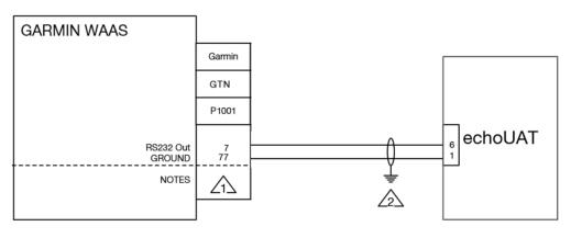
✓¹ WIRING TO BE 22 AWG✓ GROUND SHEILD AT TRANSPONDER
